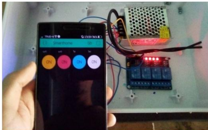
ภาพประกอบที่ 11 การทดลองควบคุมการเปิดไฟฟ้าผ่านแอปพลิเคชัน Blynk
