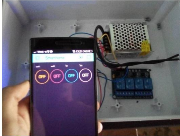
ภาพประกอบที่ 12 การทดลองควบคุมการปิดไฟฟ้าผ่านแอปพลิเคชัน Blynk
